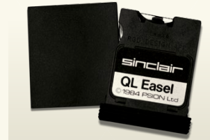
Die Microdrives hatten technisch mehr Ähnlichkeit mit Disketten als mit Kassetten
